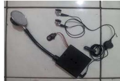
Gambar 2. Stetoskop Elektronik
