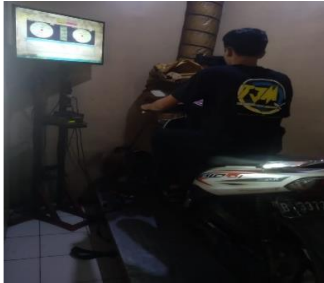
Gambar 5. Proses Pengukuran Kecepatan Motor Menggunakan Dynotest
