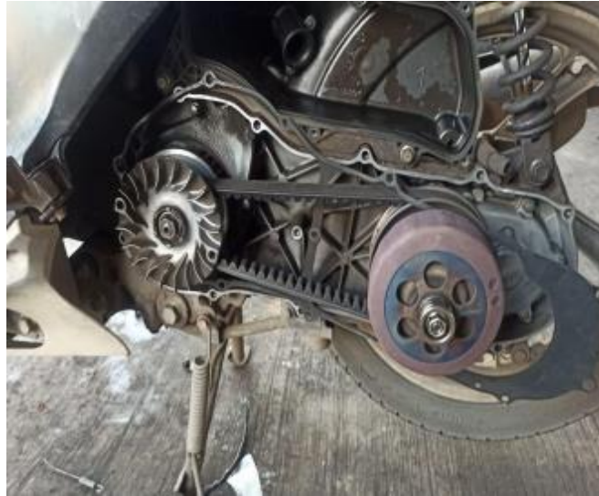
Gambar 6. Pembongkaran dan Pemasangan Roller dan Per Racing Eksperimen
