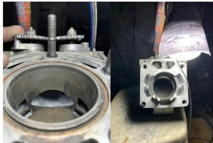
Untuk membantu siklus masuknya dan keluarnya bahan bakar dan udara kedalam ruang silinder setelah selesai maka melakukan pengantian silinder blok dengan silinder blok yang sudah dilakukan modifikasi (porting), Kemudian pengambilan data Dynotest dengan blok silinder yang sudah dilakukan modifikasi.
